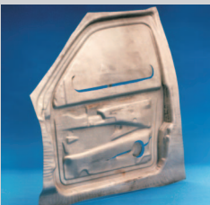
Türinnenblech aus Magnesium (Prototyp), Quelle: Volkswagen
